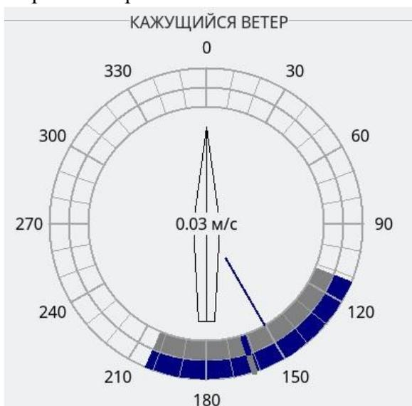
На главной панели ПО «ГМП-26» отображаются измеряемые метеорологические параметры: Температура и влажность воздуха, метеорологическая дальность видимости, высота нижней границы облачности и атмосферное давление, а также графически отображается кажущийся и истинный ветер
